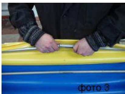
Рисунок 7. Соединение концов привальных брусьев и стрингеров с помощью выдвижных втулок
